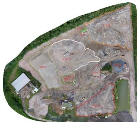
Рисунок 4. Результат вычисления объемов буртов (в м<sup>3</sup>)
