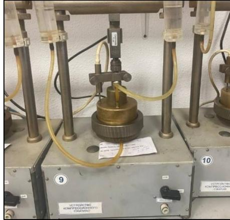
Рисунок 1. Испытание грунтов в приборах компрессионного сжатия для определения показателей просадочности
