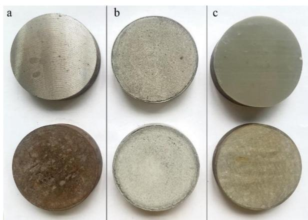
Рисунок 1. Общий вид плашек (а – металлические; b – бетонные; с – стеклопластик)
