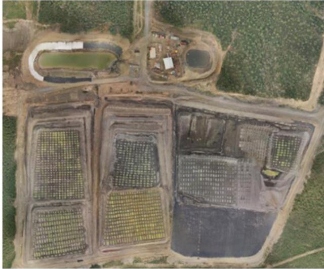
Рисунок 4. Ортофотоплан участка кучного выщелачивания
